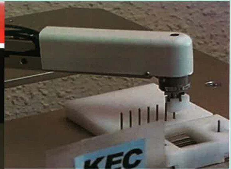
Φ1.2-1.20mmシャフトの搬送と整列 横置きシャフトを吸着して立ててトレイに整列。鉛筆の様な 片方だけ尖ったシャフト等の向きを揃える事も可能です。
