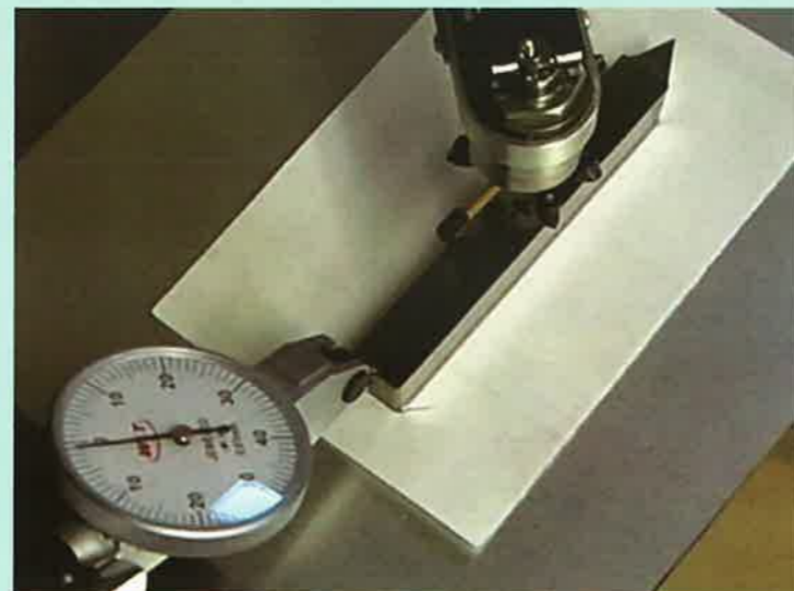
旋盤のハットの搬送実験 (傾きを補正する6本爪を使用 約62g)
